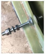
Schritt 2: Muttern und Beilagscheiben von Gewindestift herunterdrehen.
