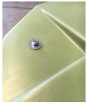
Schritt 8: Gewindestift mit Beilagscheibe und Mutter verschrauben.
