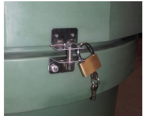
Schritt 21: Sicherheitsschloss an beiden Winkeln montieren.
