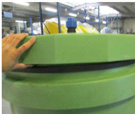
Schritt 17: Abdeckung zentrisch auf U-Profil Dichtung stecken.
