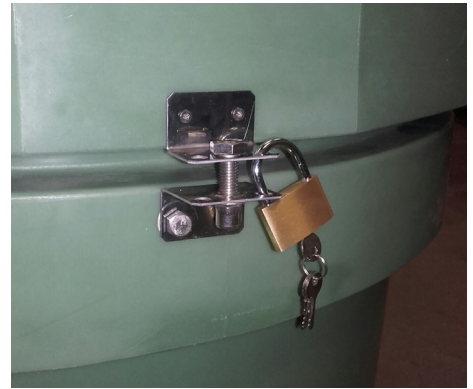
Schritt 21: Sicherheitsschloss an beiden Winkeln montieren
