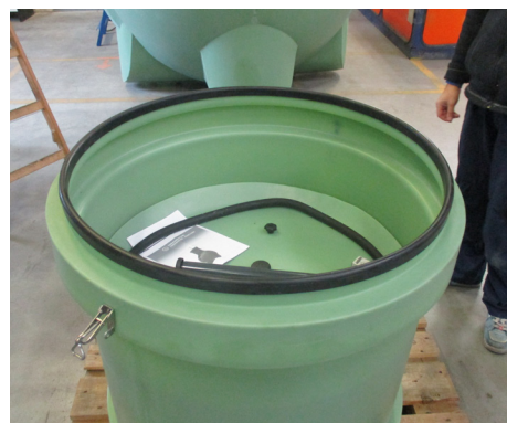
Schritt 3: Abdeckung entfernen (Belüftungsrohr, Anleitung, Rundschnurdichtung im Domschacht und Sicherheitsschlösser)
