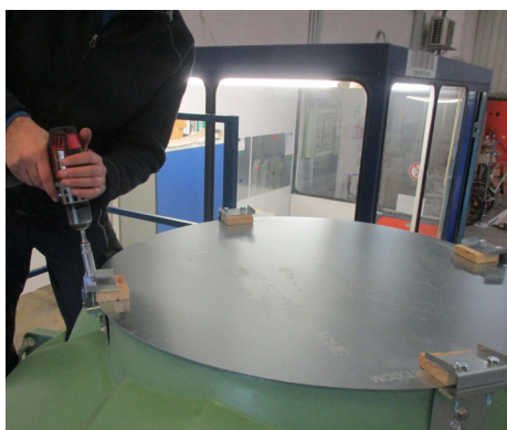
Schritt 8: Sechskantschrauben von Transportsicherungsplatte lösen. ( ACHTUNG: Transportsicherungsplatte darf nicht als Trittfläche verwendet werden)
