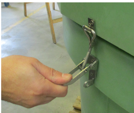
Schritt 2: Schnallen öffnen
