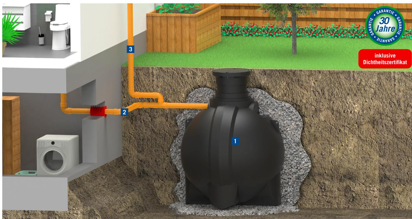
Ist ein Anschluss an einen Kanal oder eine biologische Kleinkläranlage nicht möglich, wird ein Abwasserspeicher **1** verwendet. Die Tanks werden nahtlos in einem Stück gefertigt, dadurch sind die Tankinnenflächen besonders glatt und es werden Ablagerungen vermieden. Die optimierte Tankgeometrie und hohe Wandstärke gewährleisten eine hohe Stabilität. Zusätzlich wird jeder Abwasserbehälter mit einem Dichtheitszertifikat geliefert.
