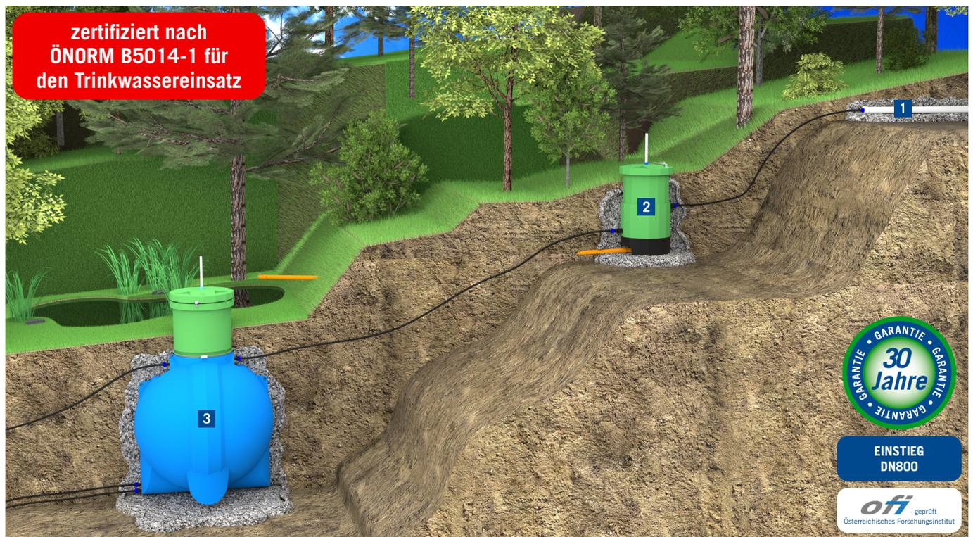
Mittels Quellwassersammelrohr **1** können Sie Ihre Quelle fassen. Mit dem Quellschacht **2** wird das Quellwasser entsandet, gereinigt und belüftet. Das gereinigte Wasser wird anschließend in den Trinkwassertank **3** geleitet und dort bis zur weiteren Verwendung gelagert.
