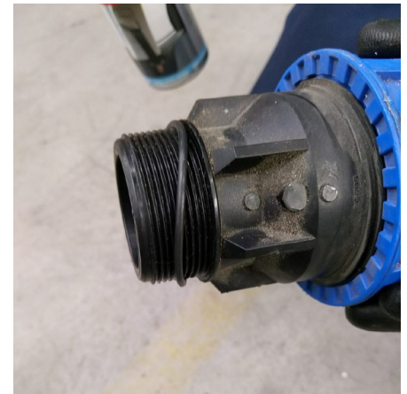
Schritt 14: O-Ring auf die ASKV-Verschraubung schieben
