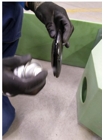
Schritt 10: Öffnung für die Zulaufdichtung sowie die Zulaufdichtung mit Silikonspray einsprühen.
