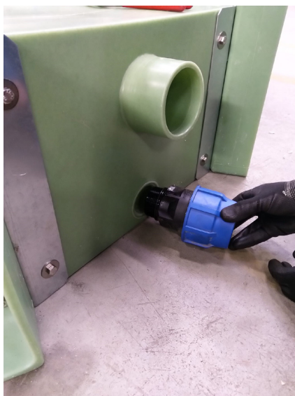
Schritt 16: ASKV-Verschraubung inklusive O-Ring in das vorgefertigte Gewinde schrauben.
