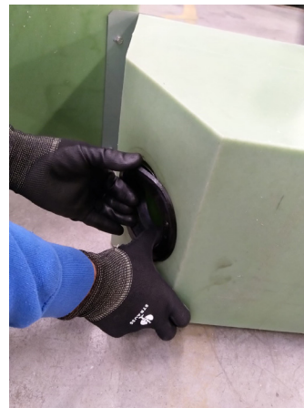
Schritt 11: Zulaufdichtung in der Öffnung, wie abgebildet, platzieren.
