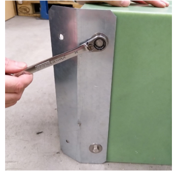
Schritt 2: Befestigungswinkel mit 4 Stk. M8 x16mm Sechskantschrauben und Beilagscheiben befestigen und mit Schraubenschlüssel festziehen.
