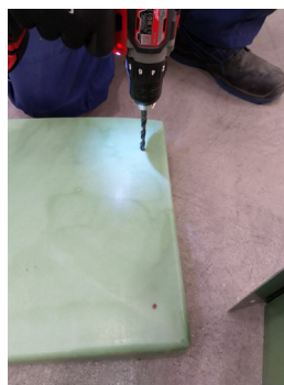
Schritt 5: Die Markierungen mit einem 9mm Bohrer aufbohren.
