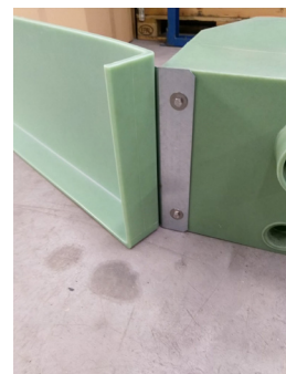
Schritt 3.1: Es ist darauf zu achten, dass sich die Kante des Flügelements in einer Linie zu der Kante des Befestigungswinkels befindet.
