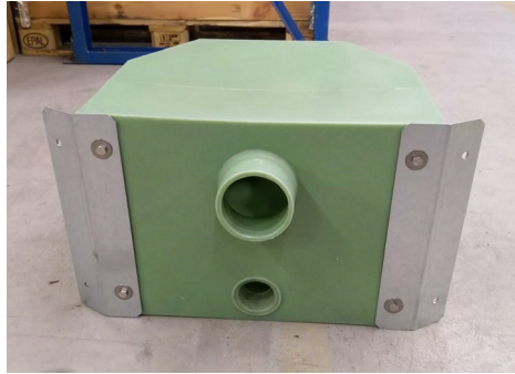
Schritt 2: Befestigungswinkel mit 4 Stk. M8 x16mm Sechskantschrauben und Beilagscheiben befestigen und mit Schraubenschlüssel festziehen.
