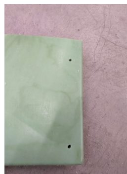
Schritt 5: Die Markierungen mit einem 9mm Bohrer aufbohren.
