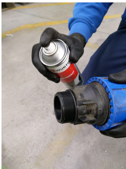
Schritt 15: ASKV-Verschraubung inklusive O-Ring mit Silikonspray einsprühen.
