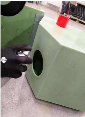
Schritt 10: Öffnung für die Zulaufdichtung sowie die Zulaufdichtung mit Silikonspray einsprühen.
