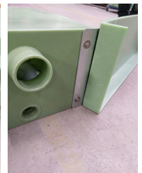
Schritt 3.1: Es ist darauf zu achten, dass sich die Kante des Flügelements in einer Linie zu der Kante des Befestigungswinkels befindet.
