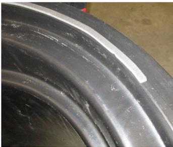
Flachdichtung am Teleskopdomschacht
