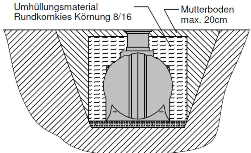
**VOR DEM UMHÜLLEN DES WASSERSPEICHERS MÜSSEN ALLE TANKVERSCHRAUBUNGEN, ANSCHLÜSSE, STECKVERBINDUNGEN,... AUF DICHTHEIT ÜBERPRÜFT WERDEN!**
