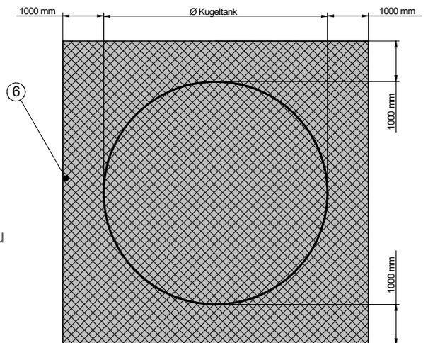
Wird der Tank mit bis zu 40 Tonnen kurzzeitig überfahren, ist eine fachgerechte Betonlastableitungsplatte herzustellen. Diese Platte muss den Tank seitlich umlaufend mindestens 1m überragen. Die Betonlastableitungsplatte ist den örtlichen Gegebenheiten/Anforderungen anzupassen. Daher ist eine fachgerechte statische Auslegung notwendig, um zu gewährleisten, dass die Betonlastableitungsplatte alle auftretenden Kräfte ans Erdreich weiterleitet und keine Belastung am Tank selbst auftritt.
